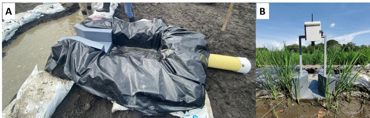
**Figura 4.** (A.) Canaleta tipo Parshall y (B.) Sensor ultrasónico para determinar caudal de riego
