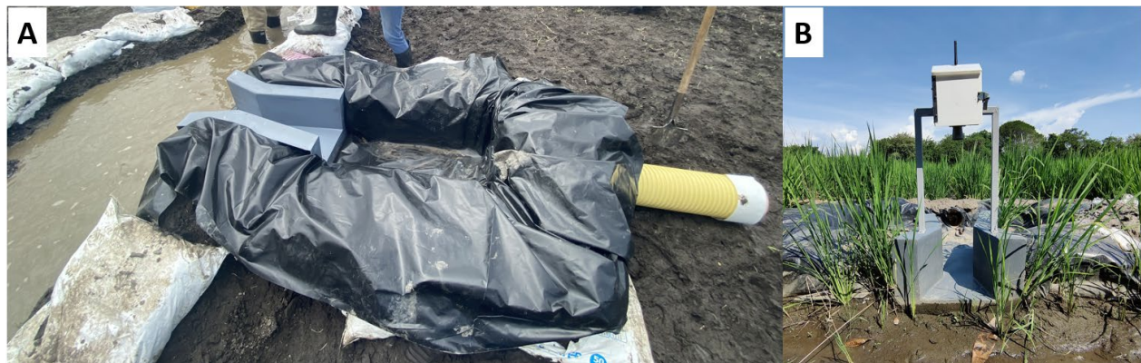
Figura 4. (A.) Canaleta tipo Parshall y (B.) Sensor ultrasónico para determinar caudal de riego Fuente: elaboración propia
